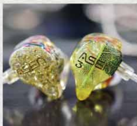
▲ AE-M3：3 動鐵單元耳機 (2 路分音設計)
