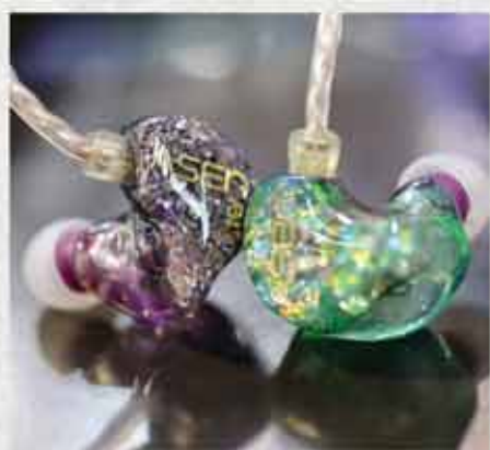
▲ AE-M2：2 動鐵單元 (2 路分音設計)
