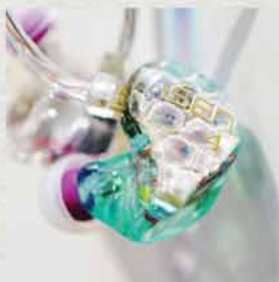
▲ AE-M4：4 動鐵單元耳機 (2 路分音設計)
