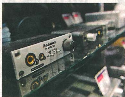
要真正感受到高清數碼音樂檔案的質素，電腦需要使用外置的解碼器，來進行24bit和96kHz的解碼工作。
